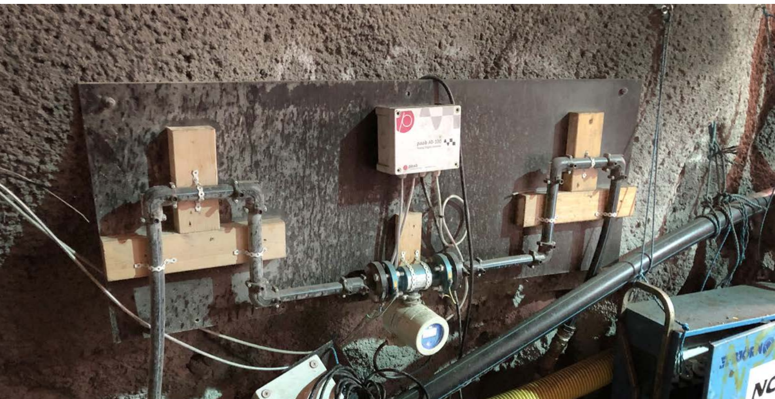
Bild från NCC, Västlänken Göteborg. Flödesmätare kopplad till Paab AD-102 WiFi
